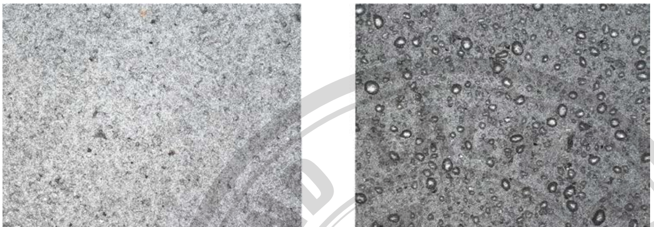
Abb. 5 // CLSM-Aufnahme der Beschichtungs Oberfläche vor (links) und nach (rechts) der mechanischen Belastung des Nassabriebtests; 20-fache Vergrößerung.
