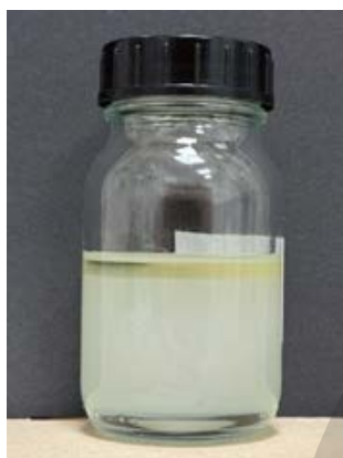
Abb. 3 // Phasentrennung in der Mischung Bisphenol A/F-Harz mit 2-Ethylhexylester FS4 (25 %iq).
