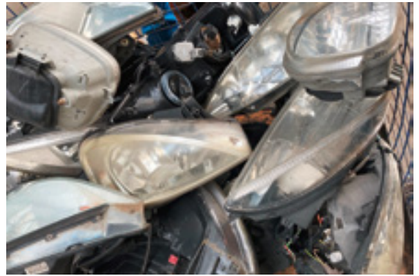
Abb. 1 // Scheinwerfergehäuse aus Polycarbonat. Dessen Beschichtung kann das Recycling erschweren.
