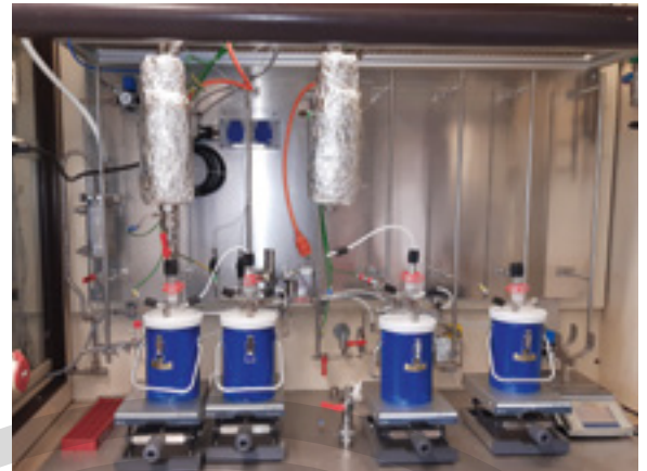
Abb. 2 // Versuchsaufbau: Der Pyrolysereaktor (oben links) wird auf 300 bis 500 °C erhitzt und von Stickstoff durchströmt. Zwei Kühlfallen (blau) fangen die flüchtigen Produkte auf.
