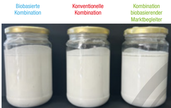
Abb. 9 // Ergebnis der Lagerung der Farben für 28 Tage bei 50 °C.
