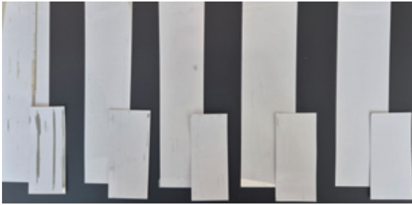
Abb. 4 // Bilder des Abriebtests mit 750 g Gewicht und 1000 Doppelhüben. Von links nach rechts: Weißlack ohne Wachs, und mit Dispersion 1 bis 4. Alle vier Dispersionen zeigen eine ähnliche Performance und verbessern die Abriebfestigkeit im Vergleich zur Beschichtung ohne Wachs erheblich.
