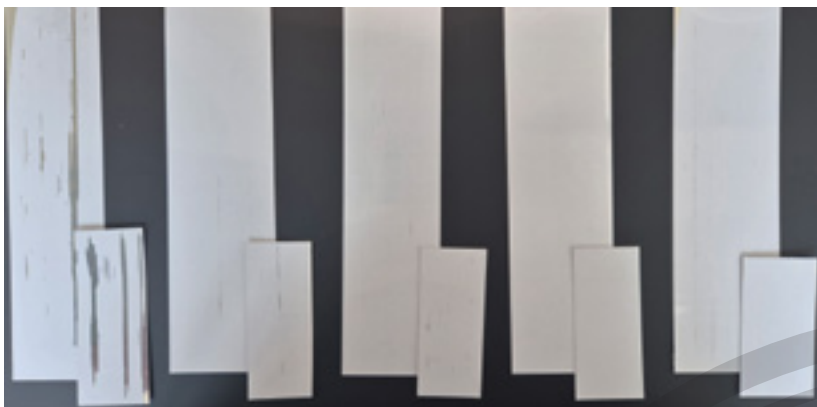
Abb. 5 // Bilder des Abriebtests mit 750 g Gewicht und 1000 Doppelhüben. Von links nach rechts: Weißlack ohne Wachs, und mit Dispersion 5, Dispersion 6, mikronisiertes Wachs 1 und mikronisiertes Wachs 2. Das PTFE-haltige mikronisierte Wachs 1 übertrifft das PTFE-freie mikronisierte Wachs 2. Allerdings zeigt auch Dispersion 6 eine sehr gute Performance.
