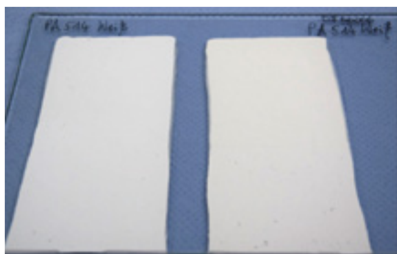
Abb. 6 // Wasserbeständigkeit der konventionellen Dispersionsfarbe (links) im Vergleich zu einer proteinbasierten Dispersionsfarbe, in der das Standardbindemittel zu 50 % durch phosphoryliertes Erbsenprotein ersetzt wurde (rechts). Es sind keine Unterschiede zwischen Referenz und proteinbasierter Farbe zu erkennen.
