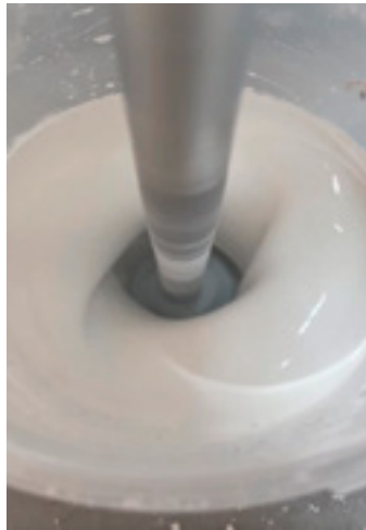
Abb. 3 // Herstellung der Dispersionsfarbe: Einstellung des Doughnut-Effekts mit den zur Untersuchung bereitgestellten Proteinbindemittel-Mischungen.
