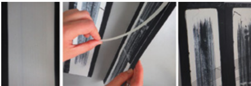
Abb. 4 // links: Standardweiß nach dem Nassabrieb-Versuch, Mitte und rechts: Nassabrieb der Dispersionsfarbe bei vollständigem Ersatz der Acrylate durch Erbsenprotein-Isolat.
