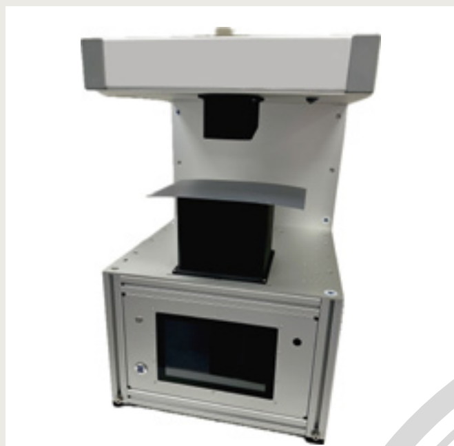
Abb. 7 // Permittivitätsmessung einer lackierten Folie.
