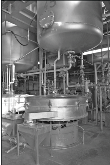
Abbildung II-2.4: Anlage für die Siebung von Aluminium-Flakes
