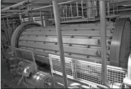
Abbildung II-2.3: Kugelmühle für die Vermahlung von Aluminiumgrieß zum Flake
