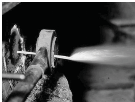
Abbildung II-2.1: Verdüsen von flüssigem Aluminium unter hohem Luftdruck
